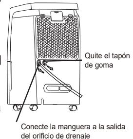
**Nota:** Cuando no se utilice la función de drenaje continuo, retire la manguera de drenaje de la toma y vuelva a colocar el tapón de goma.
